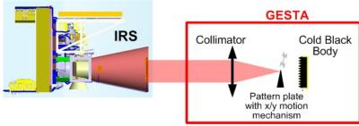
Fig. 6 Knife Edge Measurement set-up
