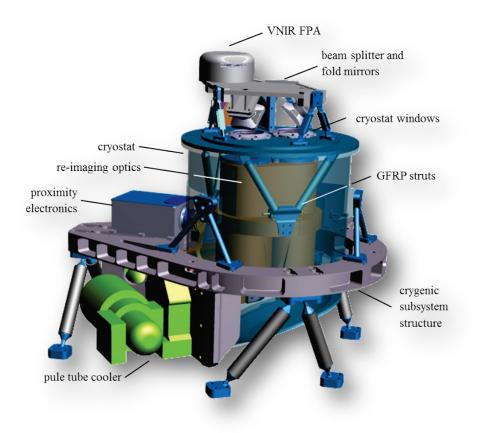
Fig. 6 Cryogenic subsystem.
