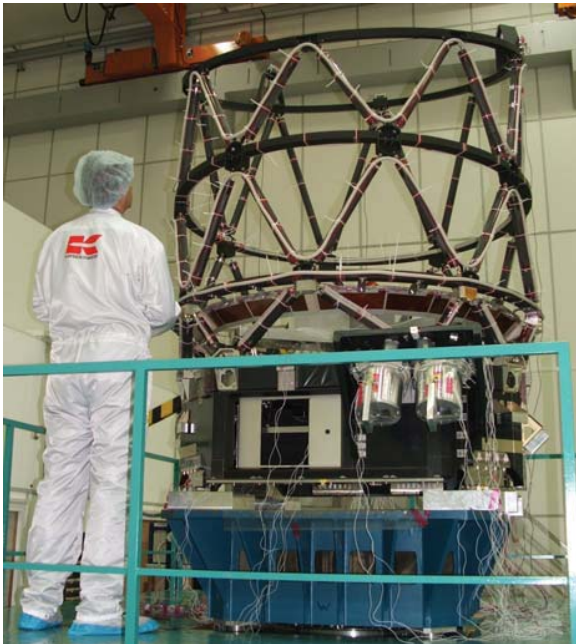
Fig. 17. PFM Vibration Test at IABG
