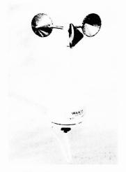
Fig. 11 Anemometer
